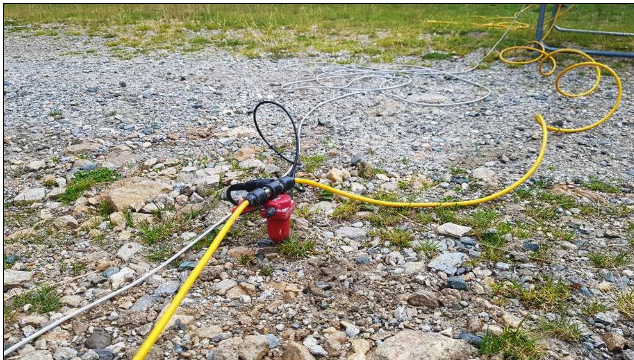
Foto 2 – Posizionamento dei cavi sismici e collegamento con i geofoni
