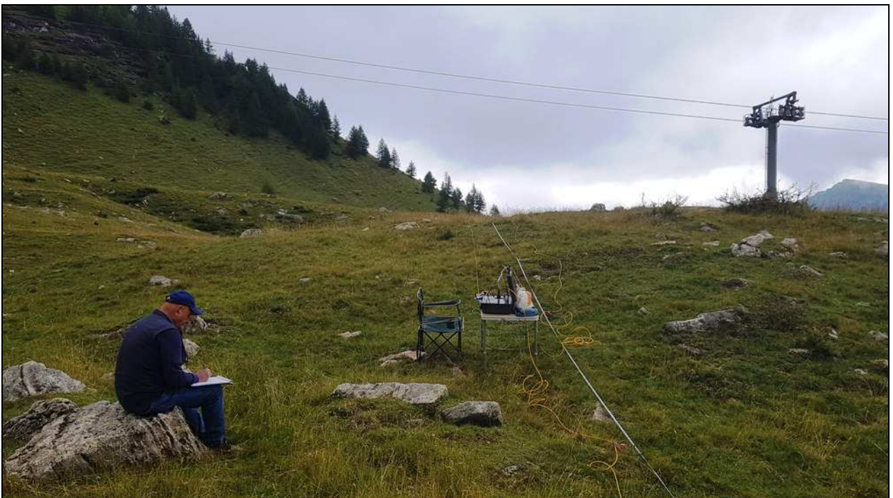
Foto 6 – Stesa R3. In primo piano è visibile il sismografo, al centro della stesa, fra il geofono 12 ed il geofono 13
