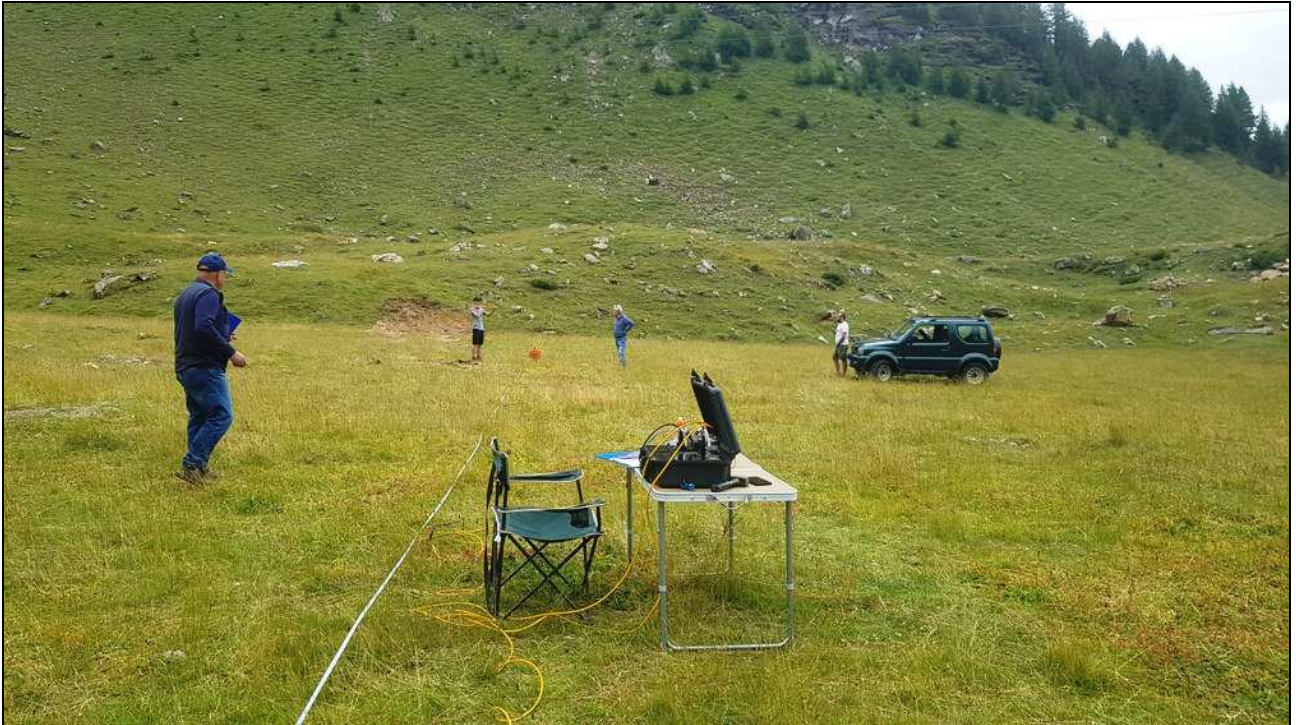
Foto 5 – Stesa R2. In primo piano è visibile il sismografo, al centro della stesa, fra il geofono 12 ed il geofono 13
